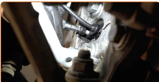
**11** Αφαιρέστε τον αισθητήρα του ABS από το μπουαγιέ. Χρησιμοποιήστε ένα μυτοσίμπιδο.
