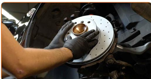
**24** Σφίξτε τις βίδες του δίσκου των φρένων. Χρησιμοποιήστε ένα Άλεν Νο.Η6 Χρησιμοποιήστε ένα δυναμόκλειδο. Σφίξτε τη με ροπή 9 Nm.
