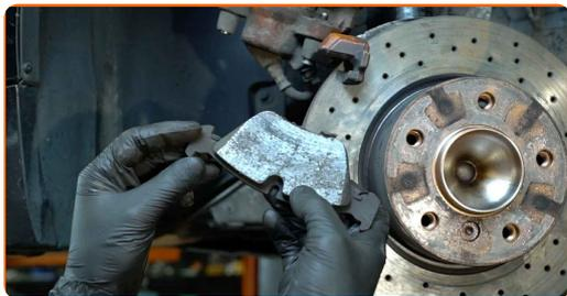
**16** Καθαρίστε τα στοιχεία στερέωσης της βάσης της δαγκάνας των φρένων. Χρησιμοποιήστε μια συρματόβουρτσα. Χρησιμοποιήστε σπρέι WD-40.
