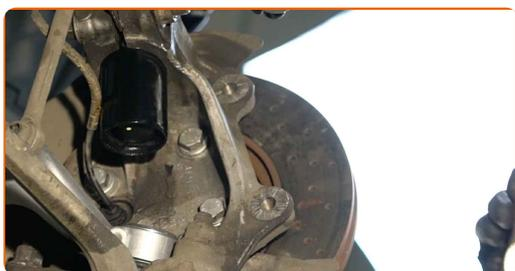
**19** Καθαρίστε τα στοιχεία στερέωσης του δίσκου των φρένων. Χρησιμοποιήστε μια συρματόβουρτσα. Χρησιμοποιήστε σπρέι WD-40.
