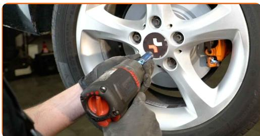
**35** Χαμηλώστε το αυτοκίνητο και χρησιμοποιήστε σταυρό, προκειμένου να σφίξετε τα μπουλόνια των τροχών. Χρησιμοποιήστε κρουστικό καρυδάκι για μπουλονόκλειδο No #17. Χρησιμοποιήστε ένα δυναμόκλειδο. Σφίξτε τη με ροπή 120 Nm.
