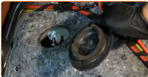
**9** Χαλαρώστε το επάνω στοιχείο στερέωσης του αμορτισέρ. Χρησιμοποιήστε ένα καρυδάκι αμορτισέρ DDN#6. Χρησιμοποιήστε ένα καρυδάκι #16. Χρησιμοποιήστε μια καστίνα.
