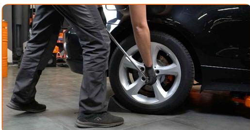
**12** Σηκώστε το πίσω μέρος του αυτοκινήτου και στερεώστε το σε στηρίγματα.
