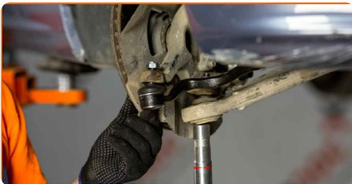
57 Σφίξτε το παξιμάδι στερέωσης που συνδέει το μπαλάκι του ακρόμπαρου με το μουαγιέ. Χρησιμοποιήστε ένα καρυδάκι #18. Χρησιμοποιήστε ένα δυναμόκλειδο. Σφίξτε τη με ροπή 65 Nm.
