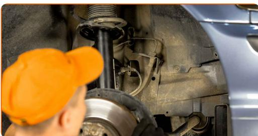
60 Σφίξτε τη βάση συγκράτησης του μαρκουτσιού των φρένων επάνω στο αμορτισέρ. Χρησιμοποιήστε ένα καρυδάκι #18. Χρησιμοποιήστε μια κασάνια.
