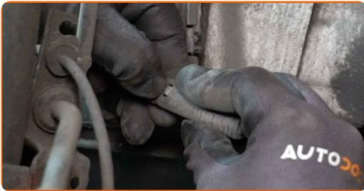
**11** Επεξεργαστείτε το φινι του αισθητήρα φθοράς του τακακιού φρένων. Χρησιμοποιήστε μονωτικό γράσο.
