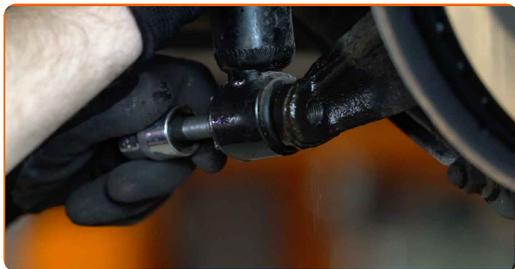
**14** Ξεβιδώστε το επάνω παξιμάδι του αμορτισέρ. Χρησιμοποιήστε ένα καρυδάκι #13. Χρησιμοποιήστε μια κασάνια.
