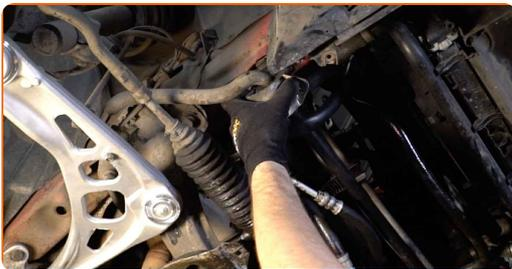
**15** Βιδώστε τα στοιχεία στερέωσης των βάσεων των σινεμπλόκ της αντιστρεπτικής δοκού. Χρησιμοποιήστε ένα καρυδάκι #16. Χρησιμοποιήστε ένα δυναμόκλειδο. Σφίξτε τη με ροπή 28 Nm.
