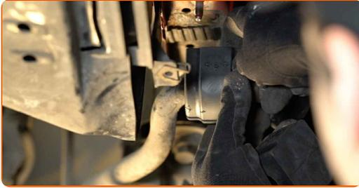
**13** Καθαρίστε τις θέσεις τοποθέτησης των σινεμπλόκ της αντιστρεπτικής δοκού. Χρησιμοποιήστε σπρέι WD-40.
