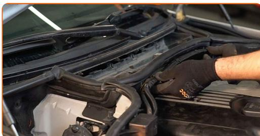
**15** Τοποθετήστε ένα νέο στοιχείο φιλτραρίσματος μέσα στο κουτί του φίλτρου. Σιγουρευτείτε ότι η άκρη του φίλτρου ταιριάζει σφικτά στο περίβλημα.
