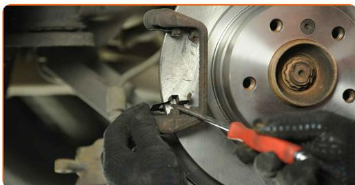
**13** Καθαρίστε τη βάση της δαγκάνας των φρένων από τη βρωμιά και τη σκόνη. Χρησιμοποιήστε μια συρματόβουρτσα. Χρησιμοποιήστε καθαριστικό φρένων.
