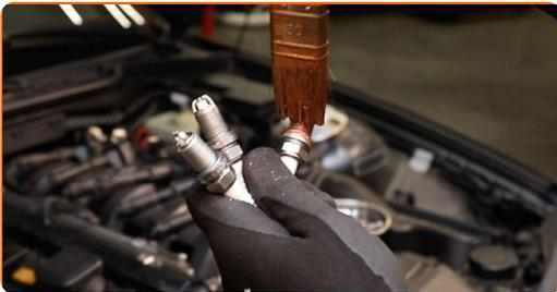
18 Τοποθετήστε τα καινούρια μπουζί στις οπές τοποθέτησής τους. Χρησιμοποιήστε ένα καρυδάκι για μπουζόκλειδο #16.
