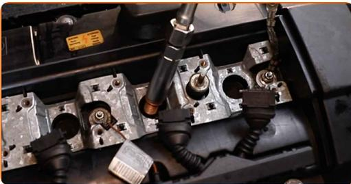
19 Βιδώστε νέα μπουζί και σφίξτε τα. Χρησιμοποιήστε ένα καρυδάκι για μπουζόκλειδο #16. Χρησιμοποιήστε ένα δυναμόκλειδο. Σφίξτε τη με ροπή 24 Nm.
