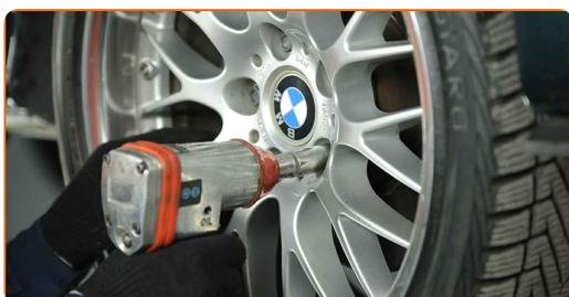
**43** Χαμηλώστε το αυτοκίνητο και χρησιμοποιήστε σταυρό, προκειμένου να σφίξετε τα μπουλόνια των τροχών. Χρησιμοποιήστε κρουστικό καρυδάκι για μπουλονόκλειδο No #17. Χρησιμοποιήστε ένα δυναμόκλειδο. Σφίξτε τη με ροπή 120 Nm.
