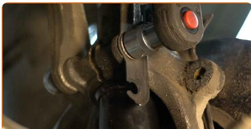
**70** Καθαρίστε τις βάσεις τοποθέτησης και το σπείρωμα του φαλιδιού της ανάρτησης. Χρησιμοποιήστε μια συρματόβουρτσα. Χρησιμοποιήστε σπρέι WD-40.
