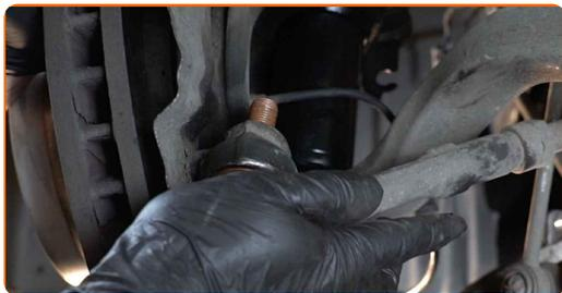
**80** Βιδώστε το παξιμάδι στερέωσης που συνδέει το ακρόμπαρο με το μουαγιέ. Χρησιμοποιήστε ένα γερμανοπολύγυνο #21. Χρησιμοποιήστε ένα Τορξ T40. Χρησιμοποιήστε μια καστάνια.
