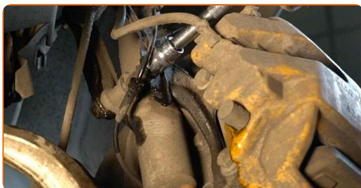
**21** Καθαρίστε το στοιχείο στερέωσης που συνδέει το μπαλάκι του ακρόμπαρου με το μουαγιέ. Καθαρίστε όλα τα συνδετικά σημεία του ψαλιδιού. Χρησιμοποιήστε μια συρματόβουρτσα. Χρησιμοποιήστε σπρέι WD-40.
