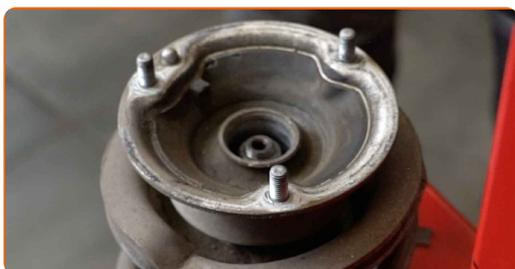
**45** Περάστε από επεξεργασία τη ράβδο του αμορτισέρ. Χρησιμοποιήστε μια συρματόβουρτσα. Χρησιμοποιήστε σπρέι WD-40.
