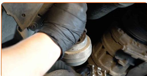
**73** Βιδώστε τα παξιμάδια του εμπρόσθιου ψαλιδιού. Χρησιμοποιήστε ένα γερμανοπολύγωνο #18. Χρησιμοποιήστε ένα καρυδάκι #18. Χρησιμοποιήστε μια καστάνια.
