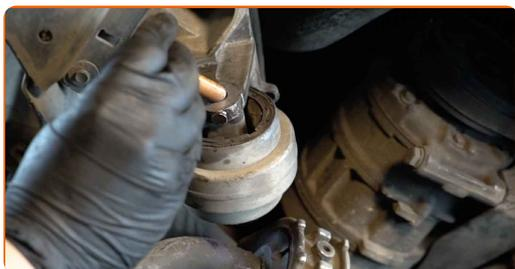
**72** Τοποθετήστε το εμπρόσθιο στοιχείο στερέωσης του ψαλιδιού.
