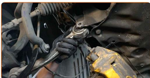
**75** Τοποθετήστε το οπίσθιο στοιχείο στερέωσης του ψαλιδιού.
