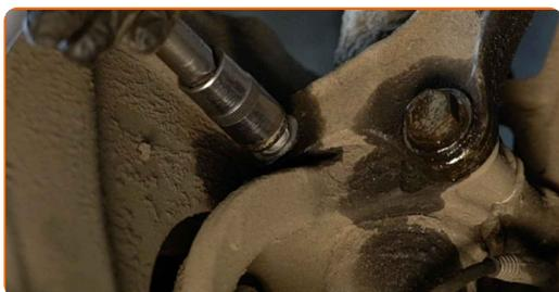
**20** Ξεβιδώστε το κάτω στοιχείο στερέωσης που συνδέει το γόνατο του αμορτισέρ με το μουαγιέ. Χρησιμοποιήστε ένα γερμανοπολύγωνο #18. Χρησιμοποιήστε ένα καρυδάκι #18. Χρησιμοποιήστε μια καστάνια.
