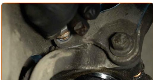
**69** Βιδώστε το στοιχείο στερέωσης που συνδέει το δίχαλο του αμορτισέρ με το μουαγιέ. Χρησιμοποιήστε ένα καρυδάκι #18. Χρησιμοποιήστε μια καστάνια.
