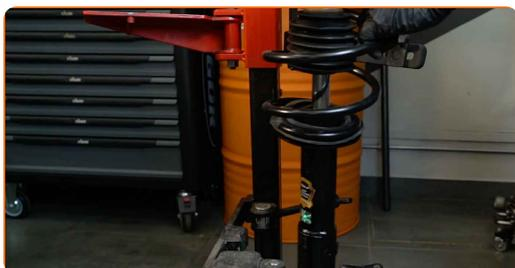
**62** Επεξεργαστείτε τη βάση του γόνατου του αμορτισέρ, επάνω στο μπουαγιέ. Χρησιμοποιήστε μια συρματόβουρτσα. Χρησιμοποιήστε σπρέι WD-40.
