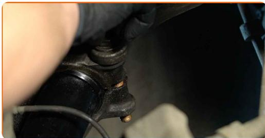
**68** Βιδώστε το στοιχείο στερέωσης του στηρίγματος ράβδου αντίστασης. Χρησιμοποιήστε ένα καρυδάκι #16. Χρησιμοποιήστε μια καστάνια.
