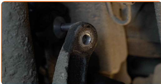
**19** Ξεβιδώστε το στοιχείο στερέωσης του στηρίγματος ράβδου αντίστασης. Χρησιμοποιήστε ένα καρυδάκι #16. Χρησιμοποιήστε μια καστάνια.
