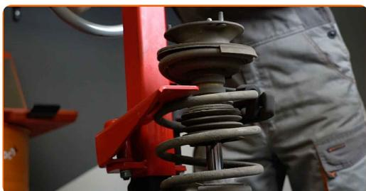
**44** Αφαιρέστε το καπάκι της βάσης του γόνατου του αμορτισέρ. Χρησιμοποιήστε ένα λοστό.
