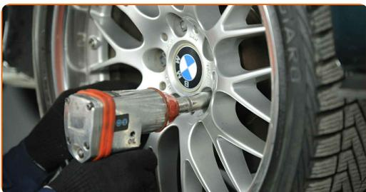
**43** Χαμηλώστε το αυτοκίνητο και χρησιμοποιήστε σταυρό, προκειμένου να σφίξετε τα μπουλόνια των τροχών. Χρησιμοποιήστε κρουστικό καρυδάκι για μπουλονόκλειδο Νο #17. Χρησιμοποιήστε ένα δυναμόκλειδο. Σφίξτε τη με ροπή 120 Nm.
