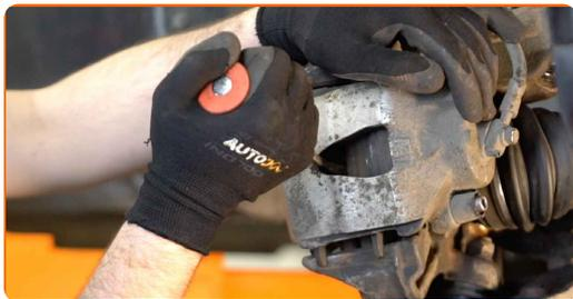
**10** Καθαρίστε τα στοιχεία στερέωσης της δαγκάνας των φρένων. Χρησιμοποιήστε μια συρματόβουρτσα. Χρησιμοποιήστε σπρέι WD-40.
