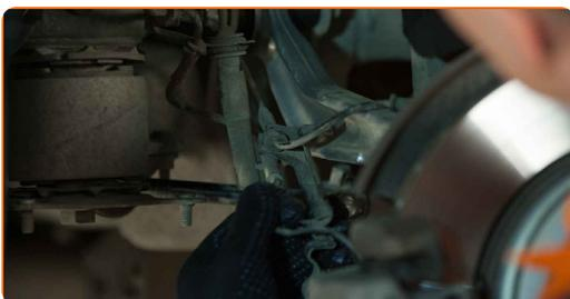
**8** Καθαρίστε όλα τα συνδετικά σημεία του ψαλιδιού. Χρησιμοποιήστε μια συρματόβουρτσα. Χρησιμοποιήστε σπρέι WD-40.
