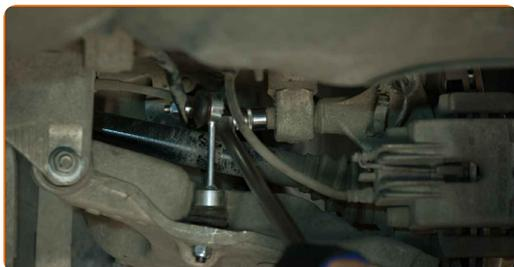
**16** Αφαιρέστε τη βίδα στερέωσης. Χρησιμοποιήστε ένα γερμανοπολύγωνο #18. Χρησιμοποιήστε ένα ίσιο κατσαβίδι.
