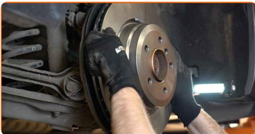
**25** Σφίξτε τις βίδες του δίσκου των φρένων. Χρησιμοποιήστε ένα Άλεν Νο.Η5 Χρησιμοποιήστε ένα δυναμόκλειδο. Σφίξτε τη με ροπή 16 Nm.
