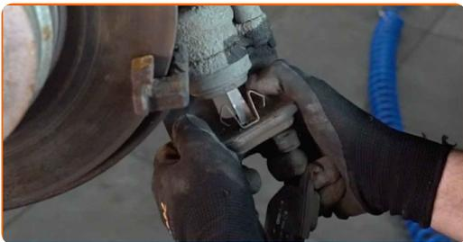
17 Καθαρίστε τα στοιχεία στερέωσης της βάσης της δαγκάνας των φρένων. Χρησιμοποιήστε μια συρματόβουρτσα. Χρησιμοποιήστε σπρέι WD-40.
