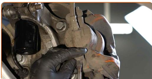
**12** Ξεβιδώστε τον σφιγκτήρα της δαγκάνας των φρένων. Χρησιμοποιήστε ένα Άλεν No.H7. Χρησιμοποιήστε μια καστανία.
