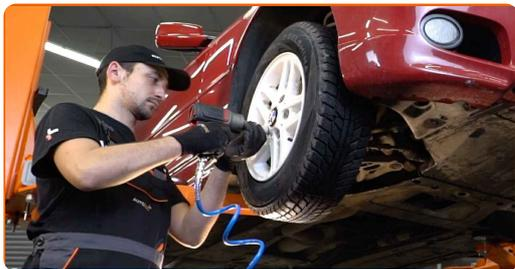
**25** Χαμηλώστε το αυτοκίνητο και χρησιμοποιήστε σταυρό, προκειμένου να σφίξετε τα μπουλόνια των τροχών. Χρησιμοποιήστε ένα δυναμόκλειδο. Σφίξτε τη με ροπή 120 Nm.
