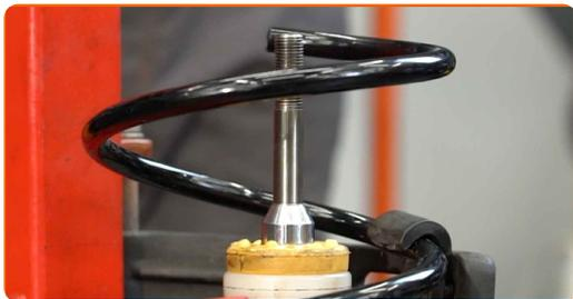
**40** Επεξεργαστείτε την άνω βάση του γόνατου ανάρτησης. Χρησιμοποιήστε σπρέι WD-40.
