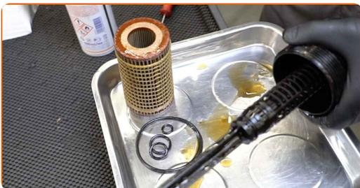
**17** Αφαιρέστε τα παλιά O-ριγκ από το κάλυμμα του φίλτρου. Χρησιμοποιήστε ένα ίσιο κατσαβίδι.
