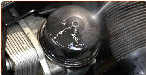
**12** Ξεβιδώστε το καπάκι του καλύμματος του φίλτρου μαζί με το παλιό στοιχείο φιλτραρίσματος. Χρησιμοποιήστε ένα καρυδάκι 74/15F. Χρησιμοποιήστε μια καστάνια.
