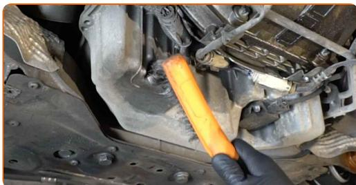
**9** Ξεβιδώστε την τάπα αποστράγγισης. Χρησιμοποιήστε ένα γερμανοπολύγωνο #13. Χρησιμοποιήστε ένα καρυδάκι #13. Χρησιμοποιήστε μια κασάνια.
