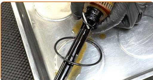
**18** Καθαρίστε το καπάκι του περιβλήματος του φίλτρου λαδιού. Χρησιμοποιήστε ένα σπρέι καθαρισμού γενικής χρήσης.
