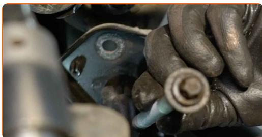
**16** Ξεβιδώστε το στοιχείο στερέωσης που συνδέει τον βραχίονα ελέγχου με το υποπλαϊσιο. Χρησιμοποιήστε ένα γερμανοπολύγωνο #18. Χρησιμοποιήστε ένα ΧΖΝ #12. Χρησιμοποιήστε μια καστίνα.
