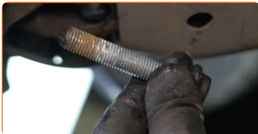
**11** Καθαρίστε τα στοιχεία στερέωσης της βάσης του υποπλασίου. Χρησιμοποιήστε μια συρματόβουρτσα. Χρησιμοποιήστε σπρέι WD-40.
