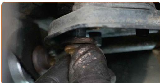
**25** Σφίξτε τα στοιχεία στερέωσης του στηρίγματος του υποπλασιίου. Χρησιμοποιήστε ένα Τορξ E10. Χρησιμοποιήστε ένα δυναμόκλειδο. Σφίξτε τη με ροπή 28 Nm.
