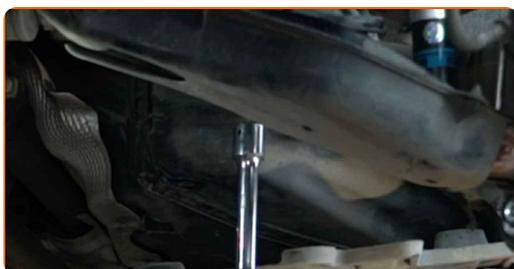
**13** Ξεβιδώστε τα στοιχεία στερέωσης του στηρίγματος του υποπλασίου. Είναι απαραίτητο για να αποκτήσετε πρόσβαση στο επάνω μπουλόνι στερέωσης του ψαλιδιού της ανάρτησης. Χρησιμοποιήστε ένα Τορξ E10. Χρησιμοποιήστε ένα Τορξ E14. Χρησιμοποιήστε μια καστάνια.
