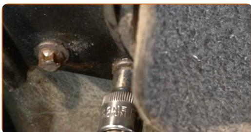
**26** Σφίξτε τα στοιχεία στερέωσης του στηρίγματος του υποπλασιίου. Χρησιμοποιήστε ένα Τορξ E14. Χρησιμοποιήστε ένα δυναμόκλειδο. Σφίξτε τη με ροπή 80 Nm.+90°
