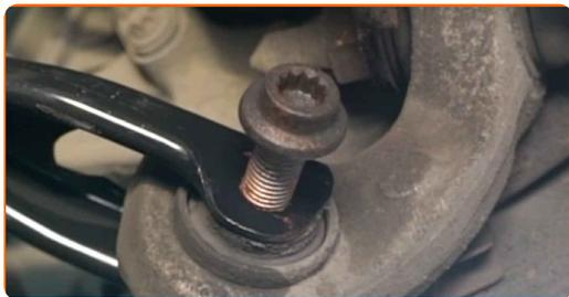
**23** Τοποθετήστε το στήριγμα του υποπλασιίου.
