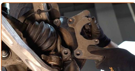
**16** Ξεβιδώστε τις βίδες του δίσκου των φρένων. Χρησιμοποιήστε ένα Τορξ T30. Χρησιμοποιήστε μια καστάνια.
