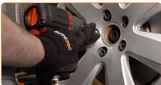
**35** Χαμηλώστε το αυτοκίνητο και χρησιμοποιήστε σταυρό, προκειμένου να σφίξετε τα μπουλόνια των τροχών. Χρησιμοποιήστε ένα δυναμόκλειδο. Σφίξτε τη με ροπή 120 Nm.
