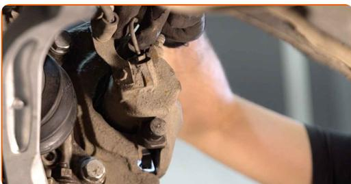
**10** Ξεβιδώστε τον σφιγκτήρα της δαγκάνας των φρένων. Χρησιμοποιήστε ένα Άλεν No.H7. Χρησιμοποιήστε μια καστάνια.
