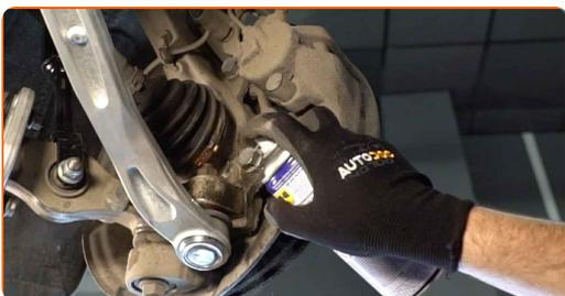
**11** Ξεβιδώστε τις βίδες της βάσης της δαγκάνας. Χρησιμοποιήστε ένα καρυδάκι #21. Χρησιμοποιήστε μια καστανία. Χρησιμοποιήστε μια μανέλα κολαούζου.
