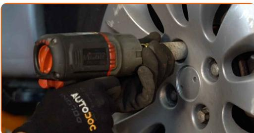
35 Χαμηλώστε το αυτοκίνητο και χρησιμοποιήστε σταυρό, προκειμένου να σφίξετε τα μπουλόνια των τροχών. Χρησιμοποιήστε ένα δυναμόκλειδο. Σφίξτε τη με ροπή 100 Nm.
