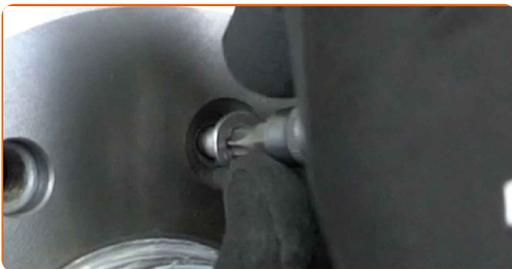
17 Σφίξτε τα στοιχεία στερέωσης των ταμπόρων φρένων. Χρησιμοποιήστε ένα Τορξ T30. Χρησιμοποιήστε ένα δυναμόκλειδο. Σφίξτε τη με ροπή 10 Nm.
