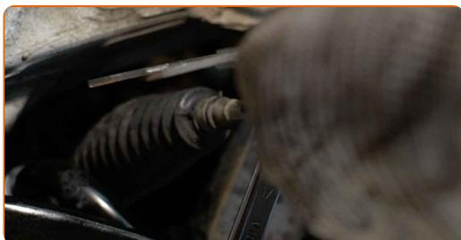
**19** Σφίξτε το παξιμάδι σύνδεσης του μπαλακιού με το ακρόμπαρο. Χρησιμοποιήστε ένα γερμανοπολύγωνο #17. Χρησιμοποιήστε ένα γερμανοπολύγωνο #19. Χρησιμοποιήστε ένα δυναμόκλειδο. Σφίξτε τη με ροπή 47 Nm.
