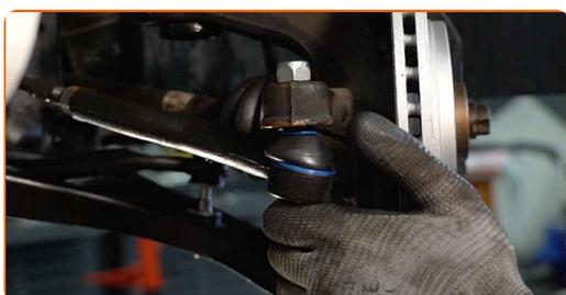
**18** Κατά την αποσύνδεση, σημειώστε ή μετρήστε την ακριβή θέση του μπαλακιού στο ακρόμπαρο, ή μετρήστε τον αριθμό περιστροφών κατά το ξεβίδωμα, για να αποφύγετε τη λανθασμένη ευθυγράμμιση στο τέλος της εργασίας. Χρησιμοποιήστε ένα παχύμετρο.
