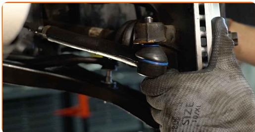
**17** Βιδώστε το παξιμάδι στερέωσης που συνδέει το ακρόμπαρο με το mouagié. Χρησιμοποιήστε ένα καρυδάκι #19. Χρησιμοποιήστε μια καστάνια.
