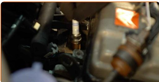
**18** Βιδώστε νέα μπουζί και σφίξτε τα. Χρησιμοποιήστε ένα καρυδάκι για μπουζόκλειδο #16. Χρησιμοποιήστε ένα δυναμόκλειδο. Σφίξτε τη με ροπή 28 Nm.
