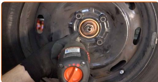
**32** Χαμηλώστε το αυτοκίνητο και χρησιμοποιήστε σταυρό, προκειμένου να σφίξετε τα μπουλόνια των τροχών. Χρησιμοποιήστε ένα δυναμόκλειδο. Σφίξτε τη με ροπή 90 Nm.
