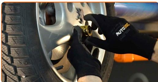
**38** Χαμηλώστε το αυτοκίνητο και χρησιμοποιήστε σταυρό, προκειμένου να σφίξετε τα μπουλόνια των τροχών. Χρησιμοποιήστε ένα δυναμόκλειδο. Σφίξτε τη με ροπή 100 Nm.
