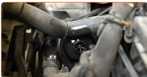
**10** Ξεβιδώστε το καπάκι του καλύμματος του φίλτρου μαζί με το παλιό στοιχείο φιλτραρίσματος. Χρησιμοποιήστε ένα καρυδάκι #27. Χρησιμοποιήστε μια καστάνια.
