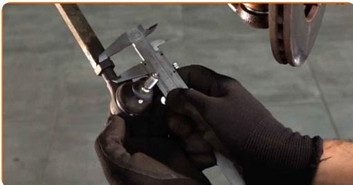
**17** Σφίξτε το παξιμάδι στερέωσης που συνδέει το μπαλάκι του ακρόμπαρου με το μουαγιέ. Χρησιμοποιήστε ένα καρυδάκι #17. Χρησιμοποιήστε ένα δυναμόκλειδο. Σφίξτε τη με ροπή 49 Nm.
