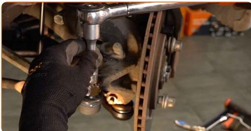
**18** Σφίξτε το παξιμάδι σύνδεσης του μπαλακιού με το ακρόμπαρο. Χρησιμοποιήστε ένα γερμανοπολύγωνο #19 (2 τεμάχια). Χρησιμοποιήστε ένα δυναμόκλειδο. Σφίξτε τη με ροπή 62 Nm.
