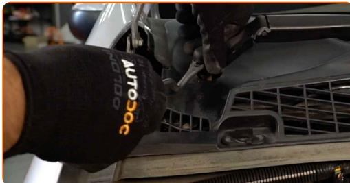
4 Ξεβιδώστε τα στοιχεία στερέωσης των βραχιόνων των υαλοκαθαριστήρων του παρμπρίζ. Χρησιμοποιήστε ένα καρυδάκι #14.
