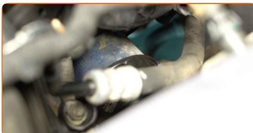
5 Ετοιμάστε ένα δοχείο για το παλιό φίλτρο λαδιού. Βάλτε το παλιό φίλτρο λαδιού στο δοχείο.
