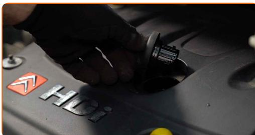
4 Ξεβιδώστε το φίλτρο λαδιού. Χρησιμοποιήστε ένα καρυδάκι 74/76-15F.
