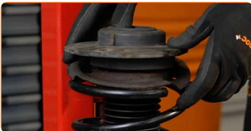
**52** Σφίξτε το παξιμάδι της ράβδου του εμπόλου του γονάτου του αμορτισέρ. Χρησιμοποιήστε ένα καρυδάκι αμορτισέρ 22 mm. Χρησιμοποιήστε ένα Άλεν Νο.Η6. Χρησιμοποιήστε ένα δυναμόκλειδο. Σφίξτε τη με ροπή 50 Nm.
