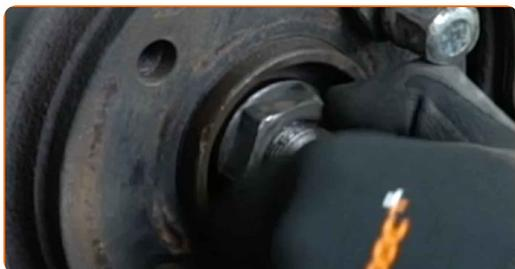
**21** Χαλαρώστε το μουαγιέ τροχού στον άξονα μετάδοσης κίνησης. Χρησιμοποιήστε ένα ζουμπά. Χρησιμοποιήστε ένα σφυρί.
