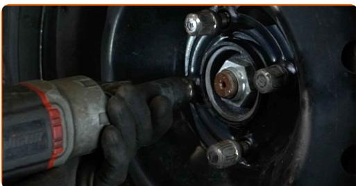
**86** Χαμηλώστε το αυτοκίνητο και χρησιμοποιήστε σταυρό, προκειμένου να σφίξετε τα μπουλόνια των τροχών. Χρησιμοποιήστε κρουστικό καρυδάκι για μπουλονόκλειδο Νο #19. Χρησιμοποιήστε ένα δυναμόκλειδο. Σφίξτε τη με ροπή 90 Nm.
