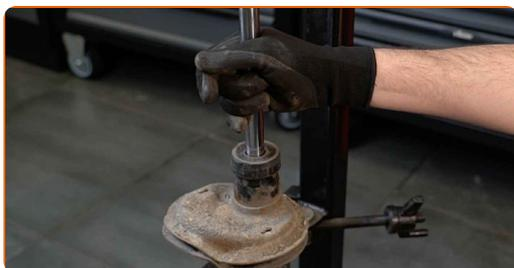
**47** Τοποθετήστε το καινούριο αμορτισέρ στον υδραυλικό συμπιεστή ελατηρίων.
