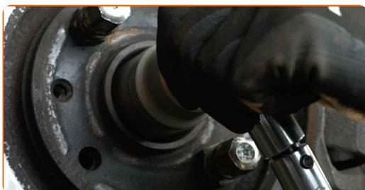
**79** Κουμπώστε το στοιχείο στερέωσης του άξονα κίνησης. Χρησιμοποιήστε ένα ίσιο σκαρπέλο μετάλλου. Χρησιμοποιήστε ένα σφυρί.
