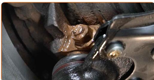
**81** Καθαρίστε το σημείο τοποθέτησης της ζάντας του τροχού. Χρησιμοποιήστε μια συρματοβούρτσα.
