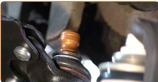
**66** Ανοίξτε το στοιχείο στερέωσης που συνδέει το μπαλάκι του βραχίονα ελέγχου με το μουαγιέ. Χρησιμοποιήστε ένα ίσιο σκαρπέλο μετάλλου. Χρησιμοποιήστε ένα σφυρί.
