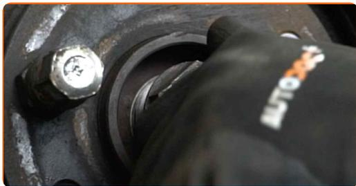
**78** Σφίξτε το παξιμάδι του άξονα κίνησης. Χρησιμοποιήστε ένα καρυδάκι #36. Χρησιμοποιήστε ένα δυναμόκλειδο. Σφίξτε τη με ροπή 320 Nm.
