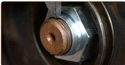
**80** Επεξεργαστείτε το στοιχείο στερέωσης στο μπαλάκι. Επεξεργαστείτε το στοιχείο στερέωσης που συνδέει το γόνατο ανάρτησης με το ακραξόνιο. Επεξεργαστείτε το στοιχείο στερέωσης που συνδέει το μπαράκι ζαμφόρ με το γόνατο ανάρτησης. Χρησιμοποιήστε γράσο χαλκού.
