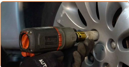
**19** Χαμηλώστε το αυτοκίνητο και χρησιμοποιήστε σταυρό, προκειμένου να σφίξετε τα μπουλόνια των τροχών. Χρησιμοποιήστε κρουστικό καρυδάκι για μπουλονόκλειδο Νο #17. Χρησιμοποιήστε ένα δυναμόκλειδο. Σφίξτε τη με ροπή 100 Nm.
