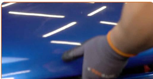
**28** Εφαρμόστε τα στοιχεία στερέωση στον βραχίονα υαλοκαθαριστήρα. Χρησιμοποιήστε γράσο χαλκού.
