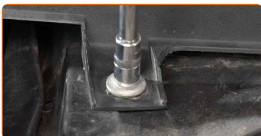
**25** Τοποθετήστε την τσιμούχα του τροπέτου των υαλοκαθαριστήρων.
