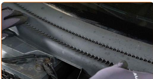
**24** Τοποθετήστε και ασφαλίστε του τροπέτο των υαλοκαθαριστήρων. Χρησιμοποιήστε ένα καρυδάκι #8. Χρησιμοποιήστε μια κασάνια. Χρησιμοποιήστε ένα σταυροκατσάβιδο.
