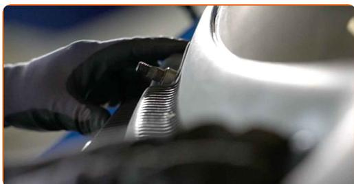
**23** Τοποθετήστε το κάλυμμα των υαλοκαθαριστήρων στην αριστερή πλευρά.
