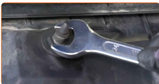
**22** Τοποθετήστε το τρομπέτο υαλοκαθαριστήρα που βρίσκεται στη δεξιά πλευρά.
