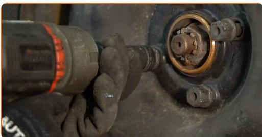
22 Χαμηλώστε το αυτοκίνητο και χρησιμοποιήστε σταυρό, προκειμένου να σφίξετε τα μπουλόνια των τροχών. Χρησιμοποιήστε κρουστικό καρυδάκι για μπουλονόκλειδο Νο #19. Χρησιμοποιήστε ένα δυναμόκλειδο. Σφίξτε τη με ροπή 110 Nm.
