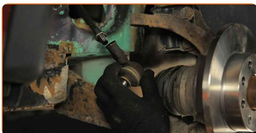
**12** Καθαρίστε τις βάσεις τοποθέτησης του ακρόμπαρου. Χρησιμοποιήστε μια συρματόβουρτσα. Χρησιμοποιήστε σπρέι WD-40.
