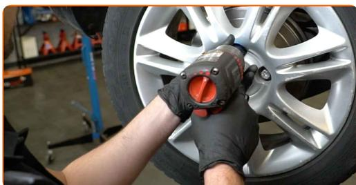
**19** Χαμηλώστε το αυτοκίνητο και χρησιμοποιήστε σταυρό, προκειμένου να σφίξετε τα μπουλόνια των τροχών. Χρησιμοποιήστε κρουστικό καρυδάκι για μπουλονόκλειδο Νο #17. Χρησιμοποιήστε ένα δυναμόκλειδο. Σφίξτε τη με ροπή 110 Nm.
