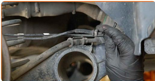
**13** Στηρίξτε τη γέφυρα της οπίσθιας ανάρτησης. Χρησιμοποιήστε ένα υδραυλικό γρύλο σασμάν.
