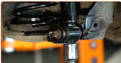
**25** Σφίξτε το κάτω παξιμάδι του γόνατου του αμορτισέρ. Χρησιμοποιήστε ένα καρυδάκι #E18. Χρησιμοποιήστε ένα δυναμόκλειδο. Σφίξτε τη με ροπή 90 Nm.
