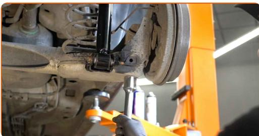
**7** Καθαρίστε τα στοιχεία στερέωσης του αμορτισέρ. Χρησιμοποιήστε μια συρματόβουρτσα. Χρησιμοποιήστε σπρέι WD-40.
