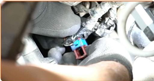
**4** Καθαρίστε το στοιχείο στερέωσης του αισθητήρα οξυγόνου. Χρησιμοποιήστε μια συρματόβουρτσα. Χρησιμοποιήστε σπρέι WD-40.
