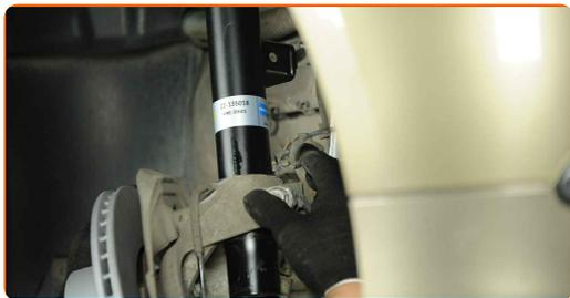
**56** Τοποθετήστε το οπίσθιο στοιχείο στερέωσης του βραχίονα ελέγχου.
