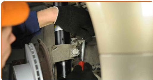
**10** Καθαρίστε το στοιχείο στερέωσης που συνδέει το μπαλάκι του ακρόμπαρου με το μουαγιέ. Χρησιμοποιήστε μια συρματόβουρτσα. Χρησιμοποιήστε σπρέι WD-40.
