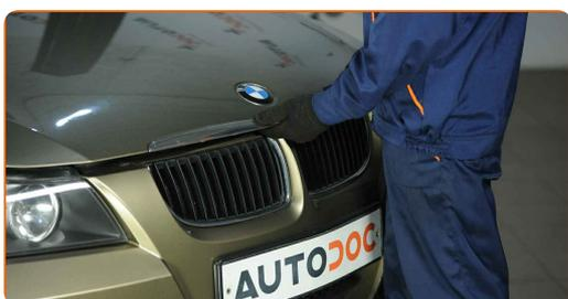
**24** Χρησιμοποιήστε ένα κάλυμμα προστασίας φτερού, για να μην προκαλέσετε ζημιές στη βαφή και τα πλαστικά τμήματα του αυτοκινήτου.
