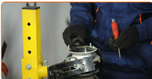
**31** Περάστε από επεξεργασία τη ράβδο του αμορτισέρ. Χρησιμοποιήστε μια συρματόβουρτσα. Χρησιμοποιήστε σπρέι WD-40.
