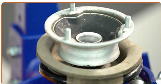
**41** Σφίξτε το παξιμάδι της ράβδου του εμβόλου του γονάτου του αμορτισέρ. Χρησιμοποιήστε ένα καρυδάκι #21. Χρησιμοποιήστε ένα δυναμόκλειδο. Σφίξτε τη με ροπή 64 Nm.
