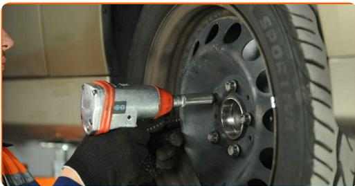
**72** Χαμηλώστε το αυτοκίνητο και χρησιμοποιήστε σταυρό, προκειμένου να σφίξετε τα μπουλόνια των τροχών. Χρησιμοποιήστε κρουστικό καρυδάκι για μπουλονόκλειδο No #17. Χρησιμοποιήστε ένα δυναμόκλειδο. Σφίξτε τη με ροπή 120 Nm.
