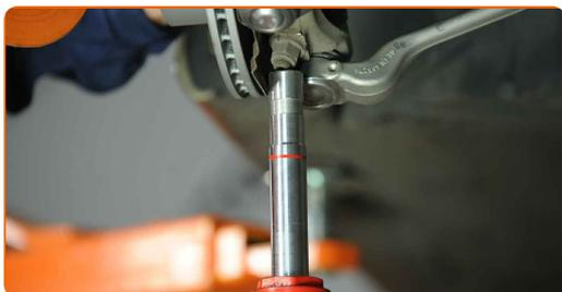
**64** Σφίξτε το εμπρόσθιο στοιχείο στερέωσης που συνδέει το βραχίονα ελέγχου με το υποπλαίσιο. Χρησιμοποιήστε ένα γερμανοπολύγωνο #18. Χρησιμοποιήστε ένα δυναμόκλειδο. Σφίξτε τη με ροπή 68 Nm.+90°
