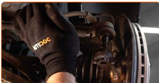
**13** Καθαρίστε τα στοιχεία στερέωσης που συνδέουν το βραχίονα ελέγχου με το υποπλαίσιο. Χρησιμοποιήστε μια συρματόβουρτσα. Χρησιμοποιήστε σπρέι WD-40.
