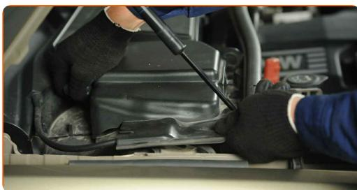
4 Αφαιρέστε το κάλυμμα των υαλοκαθαριστήρων που βρίσκεται στην αριστερή πλευρά. Χρησιμοποιήστε ένα ίσιο κατσαβίδι.
