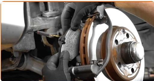
**15** Καθαρίστε τη βάση της δαγκάνας των φρένων από τη βρωμιά και τη σκόνη. Χρησιμοποιήστε μια συρματόβουρτσα. Χρησιμοποιήστε καθαριστικό φρένων.
