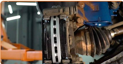
**23** Τοποθετήστε τη δαγκάνα του φρένου και σφίξτε τη. Χρησιμοποιήστε ένα καρυδάκι #13. Χρησιμοποιήστε ένα δυναμόκλειδο. Σφίξτε τη με ροπή 27 Nm.
