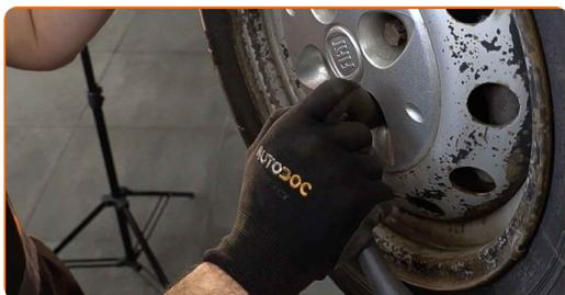
**28** Χαμηλώστε το αυτοκίνητο και χρησιμοποιήστε σταυρό, προκειμένου να σφίξετε τα μπουλόνια των τροχών. Χρησιμοποιήστε ένα δυναμόκλειδο. Σφίξτε τη με ροπή 98 Nm.
