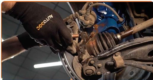
**19** Σφίξτε τη βάση της δαγκάνας των φρένων. Χρησιμοποιήστε ένα καρυδάκι #19. Χρησιμοποιήστε ένα δυναμόκλειδο. Σφίξτε τη με ροπή 57 Nm.
