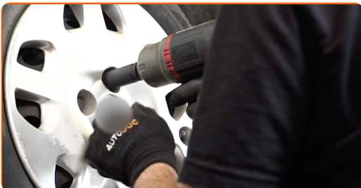
**26** Χαμηλώστε το αυτοκίνητο και χρησιμοποιήστε σταυρό, προκειμένου να σφίξετε τα μπουλόνια των τροχών. Χρησιμοποιήστε ένα δυναμόκλειδο. Σφίξτε τη με ροπή 86 Nm.
