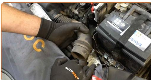
4 Ξεβιδώστε τις βίδες στερέωσης του καλύμματος του φίλτρου αέρα. Χρησιμοποιήστε ένα καρυδάκι #10. Χρησιμοποιήστε μια καστάνια.
