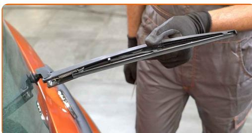
3 Πιέστε το κλιπ. Χρησιμοποιήστε ένα ίσιο κατσαβίδι.
