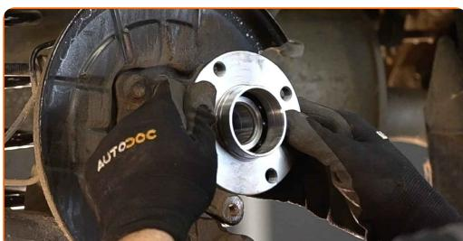
21 Σφίξτε την πλήμνη. Χρησιμοποιήστε ένα καρυδάκι #32. Χρησιμοποιήστε ένα δυναμόκλειδο. Σφίξτε τη με ροπή 224 Nm.
