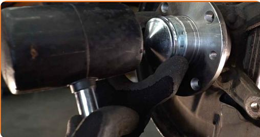
23 Περάστε από επεξεργασία το τμήμα της πλήμνης του τροχού που έρχεται σε επαφή με το δίσκο του φρένου. Χρησιμοποιήστε γράσο χαλκού.
