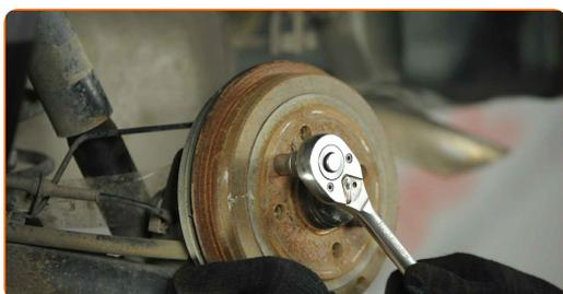
**9** Χρησιμοποιήστε ένα καρυδάκι #12. Χρησιμοποιήστε μια καστάνια.
