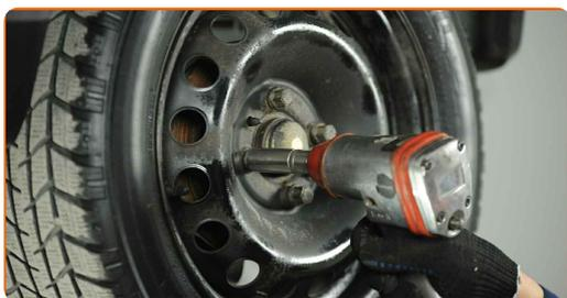
**19** Χαμηλώστε το αυτοκίνητο και χρησιμοποιήστε σταυρό, προκειμένου να σφίξετε τα μπουλόνια των τροχών. Χρησιμοποιήστε ένα δυναμόκλειδο. Σφίξτε τη με ροπή 98 Nm.
