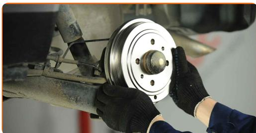
**14** Σφίξτε τα στοιχεία στερέωσης του ταμπόρου των φρένων. Χρησιμοποιήστε ένα καρυδάκι #12. Χρησιμοποιήστε ένα δυναμόκλειδο. Σφίξτε τη με ροπή 15 Nm.
