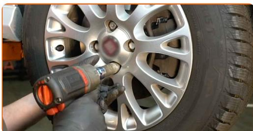
**24** Χαμηλώστε το αυτοκίνητο και χρησιμοποιήστε σταυρό, προκειμένου να σφίξετε τα μπουλόνια των τροχών. Χρησιμοποιήστε κρουστικό καρυδάκι για μπουλονόκλειδο No #17. Χρησιμοποιήστε ένα δυναμόκλειδο. Σφίξτε τη με ροπή 120 Nm.
