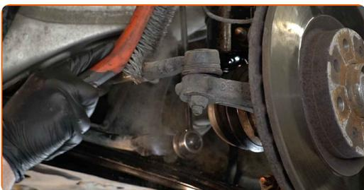
**7** Ξεβιδώστε το παξιμάδι του μπαλακιού στο μουαγιέ. Χρησιμοποιήστε ένα καρυδάκι #17. Χρησιμοποιήστε μια μανέλα κολαούζου.
