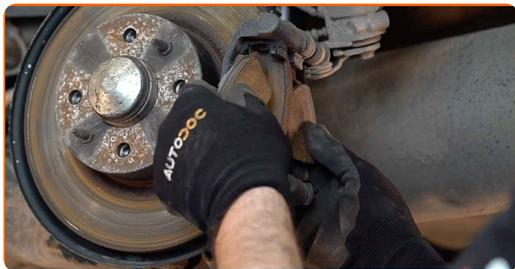
**10** Καθαρίστε τα στοιχεία στερέωσης της βάσης της δαγκάνας των φρένων. Χρησιμοποιήστε μια συρματόβουρτσα. Χρησιμοποιήστε σπρέι WD-40.
